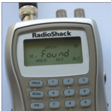
5 - Le fonctionnement du système "Signal Stalker" : on voit dans le coin en haut à droite de l'afficheur un petit signe ressemblant à un rond dans une croix qui indique le fonctionnement. Dès qu'une fréquence est capturée, l'éclairage clignote, le haut-parleur émet des bips, et l'afficheur indique "found" pour montrer qu'il a trouvé une fréquence.
