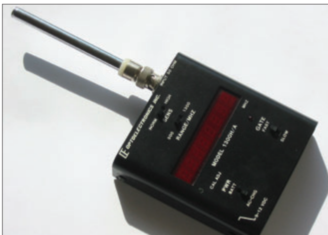
1 - Un des premiers fréquencesmètres OPTOELECTRONICS conçu pour la mesure directe de la fréquence reçue, avec un affichage à LED. L'entrée 50 ohms permet la mesure directe sur une antenne.
