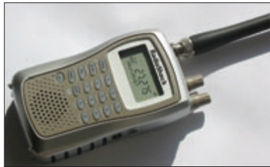
3 - Le scanner RADIO SHACK PRO-83. Petit, pas cher, très sensible, il est équipé du système "Radio Stalker" de mesure directe de fréquence d'un émetteur proche.
