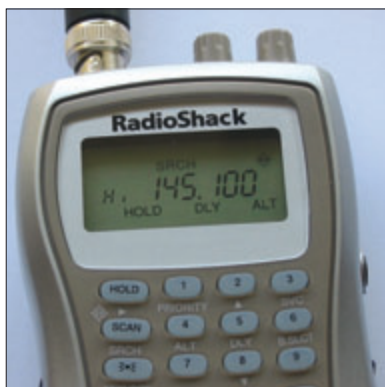
6 - Il suffit alors d'appuyer sur une touche pour faire apparaître la fonction fréquences et la valeur de la fréquence mesurée.
