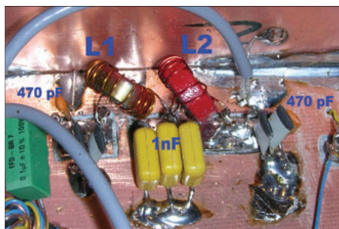
Photo 4 - Filtre passe-bas de sortie.
