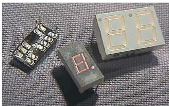
Photo 1 : Afficheurs 7 segments à diodes LED.
