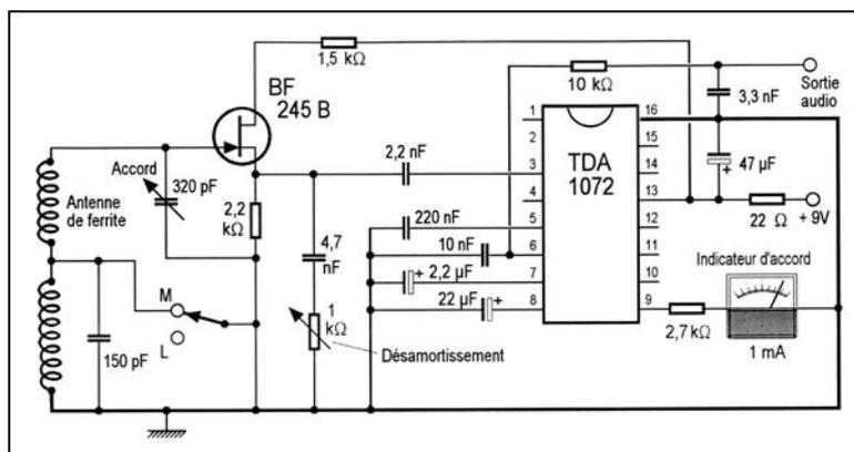
Fig. 2.— La compensation ajustable des pertes du circuit résonnant augmente la sensibilité tout en améliorant la sélectivité en imposant un filtrage plus étroit. La commutation des gammes se fait par le court-circuit de l'un des enroulements.
