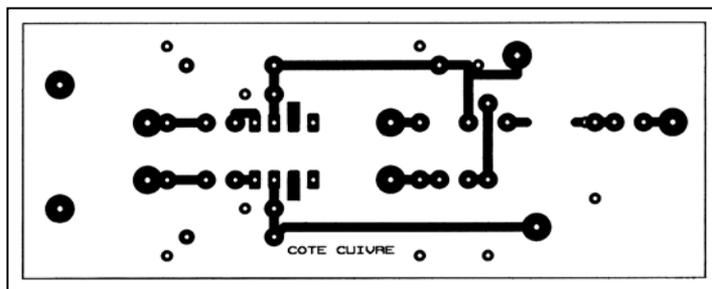
▲ Circuit imprimé côté cuivre.
