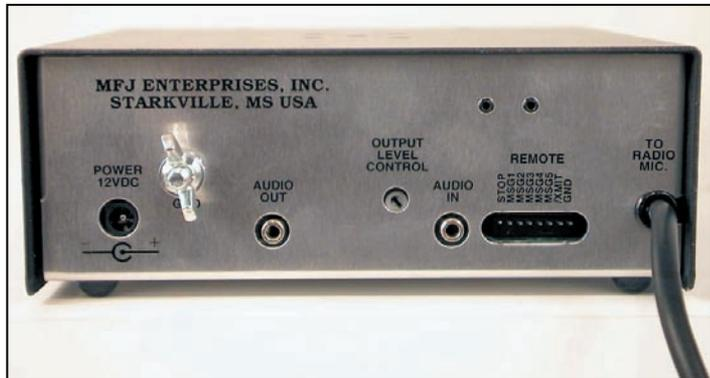
Sur la droite de la photo du panneau arrière, on aperçoit le connecteur pour la commande à distance.
