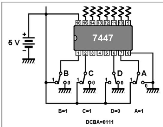
Figure 8 : Câblage des entrées du 7447.
