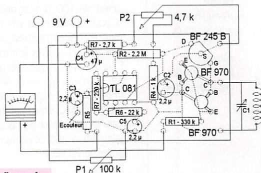
Platine imprimée supportant le circuit de la figure 1 ainsi que la variante de la figure 2.
