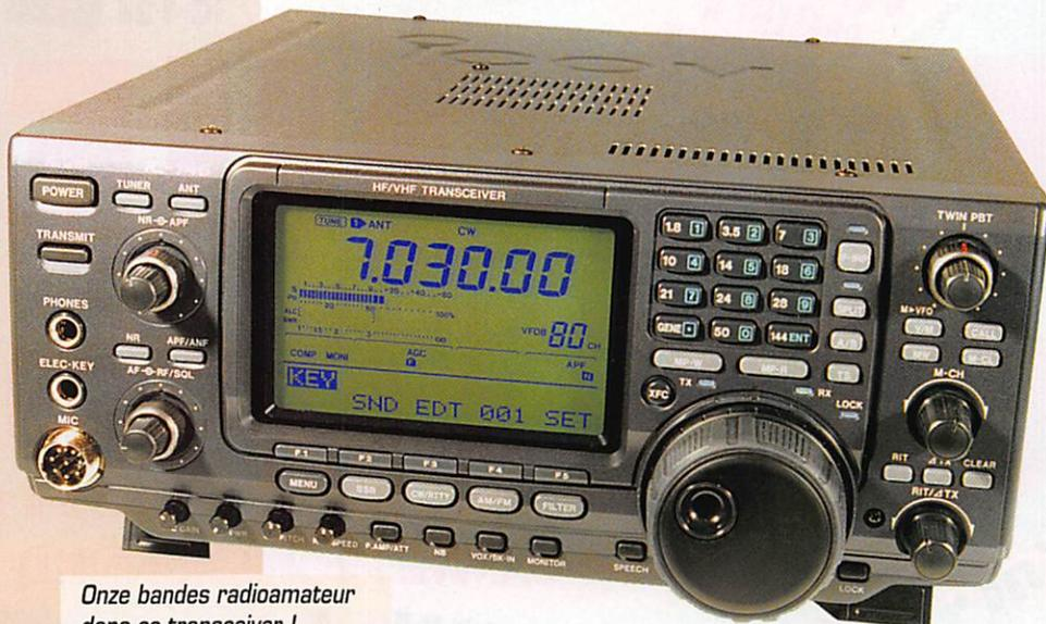
Onze bandes radioamateur dans ce transceiver !
