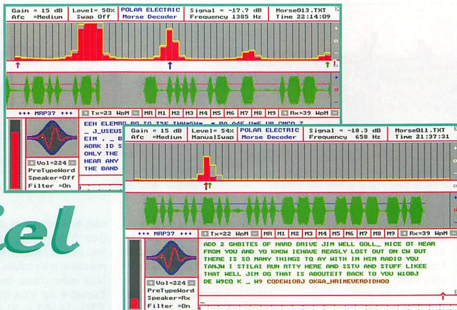
La puissance du logiciel tient également en son système de filtrage, que l'on peut mettre en ou hors service, en fonction des conditions, tout comme on peut agir sur la vitesse du CAF (pratique pour suivre les stations qui dérivent).
