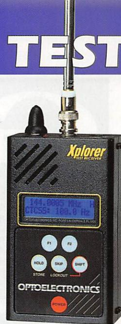
Capteur d'émissions FM proches. **XPLORER**
