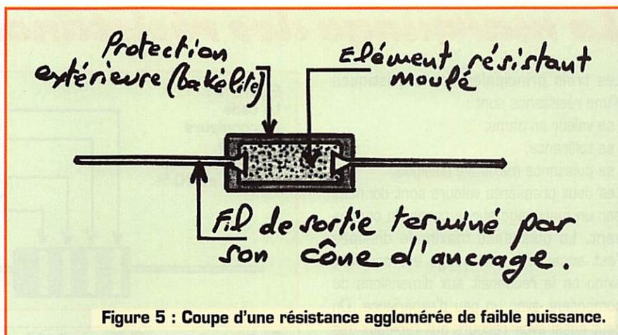
Figure 5 : Coupe d'une résistance agglomérée de faible puissance.
