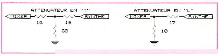
Figure 6 : Atténuateurs pour le récepteur.
