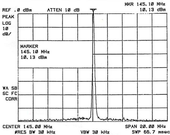
Figure 8 : Pureté de la porteuse sur 20 MHz.
