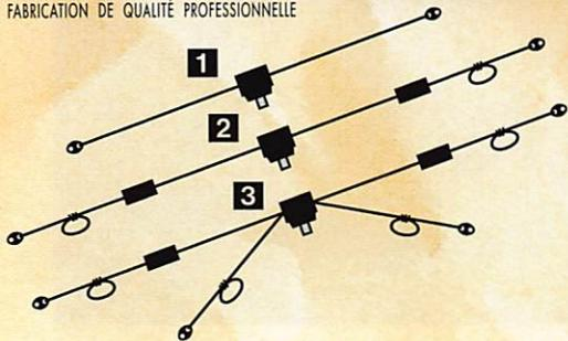
**1** DX-27 : Dipôle filaire omnidirectionnel E/R, résonance 1/2 onde, puissance 500 W, balun étanche sur ferrite fermée, câble en acier inoxydable toronné, longueur 5,5 m, avec spires de réglage 27 à 32 MHz, isolateurs (5000 V) porcelaine, gain + 3,15 dBi, livrée préréglée.
