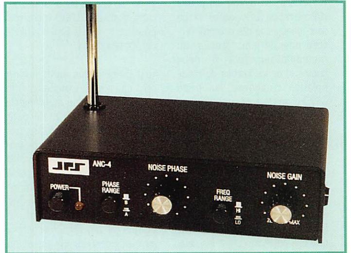
**Comment supprimer (ou réduire fortement) le bruit d'une ligne haute tension, ou toute autre source locale de parasites ? Avec un circuit HF qui compare le signal reçu par l'antenne principale de la station à celui d'une petite antenne annexe. Ensuite, on déphase de 180° et le tour est joué !**
