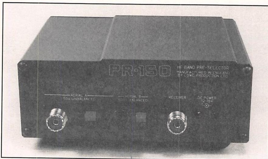
l'antenne (alimentée par coaxial) et des bornes pour antenne à ligne symétrique, voire pour un long fil. Le jack alimentation recevra du 12 à 15 V DC.
