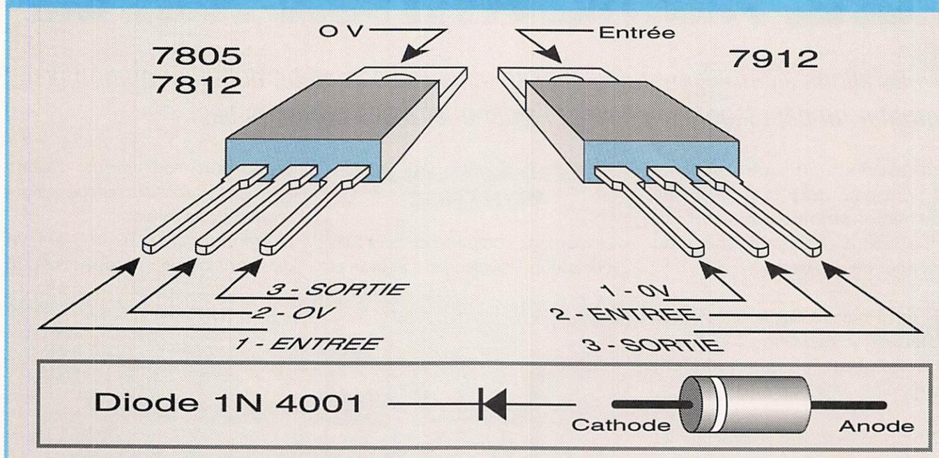
secondaire à point milieu, nous fournit une tension alternative de 2 x 9 volts en opposition de phase. Le 9 V alternatif fourni par l'enroulement AB est suivi d'un circuit redresseur doubleur de tension constitué par C1, C2, D1 et D2. Nous obtenons ainsi une tension redressée de + 18 V environ à l'entrée du régulateur 7812 qui nous donne, à son tour, la tension de + 12 V régulée disponible.
