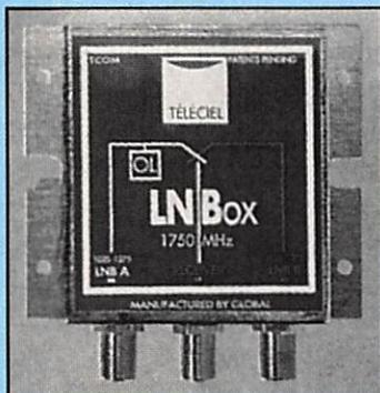
**Le boîtier Téléciel: il permet le couplage des LNB standards des deux satellites Télécom en ajoutant 335 MHz sur le signal placé en entrée A, tout en respectant le choix de polarisation V et H des chaînes. Par conséquent, il autorise la "descente" des signaux des deux satellites sur un seul câble.**
