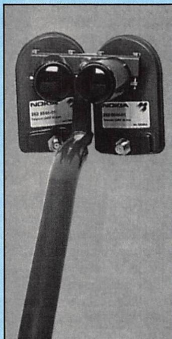
**Un exemple dans lequel les deux têtes sont placées de part et d'autre du foyer de la parabole: le kit Télécom duo de Nokia. Les deux câbles qui partent des deux têtes peuvent être soit couplés, pour ne faire plus qu'un, soit descendre jusqu'au démodulateur, s'il possède deux entrées satellite.**
