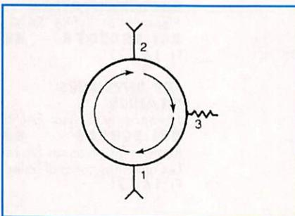
Figure 7. Isolateur à ferrite.
