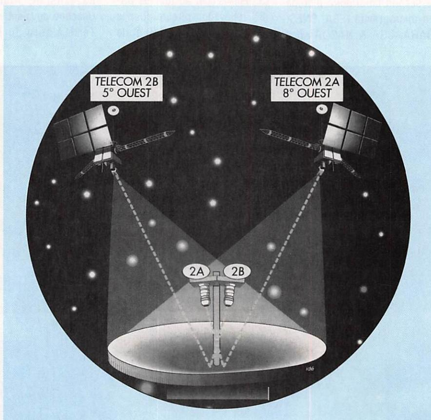
des deux têtes en plus de la conversion des bandes de fréquences. C'est le cas du monoconvertisseur de chez Visiosat, qui innove en intégrant la descente des deux signaux sur un seul câble.
