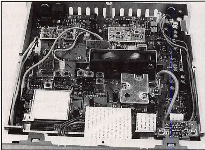
*Un ventilateur est présent à l'intérieur du transceiver (d'où le dissipateur assez réduit).*
