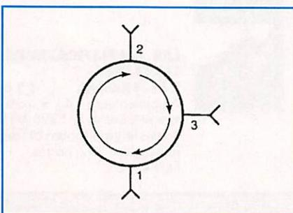
Figure 8. Circulateur à ferrite.
