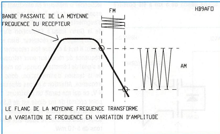
Figure 2 : Démodulation FM avec un récepteur AM.
