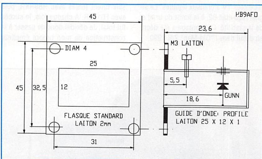
Figure 4 : Oscillateur 10 GHz à diode Gunn.
