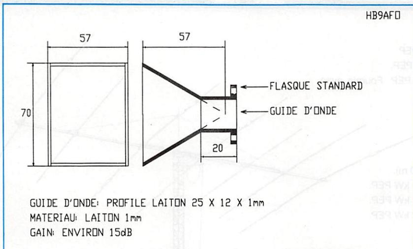
Figure 5 : Antenne cornet.
