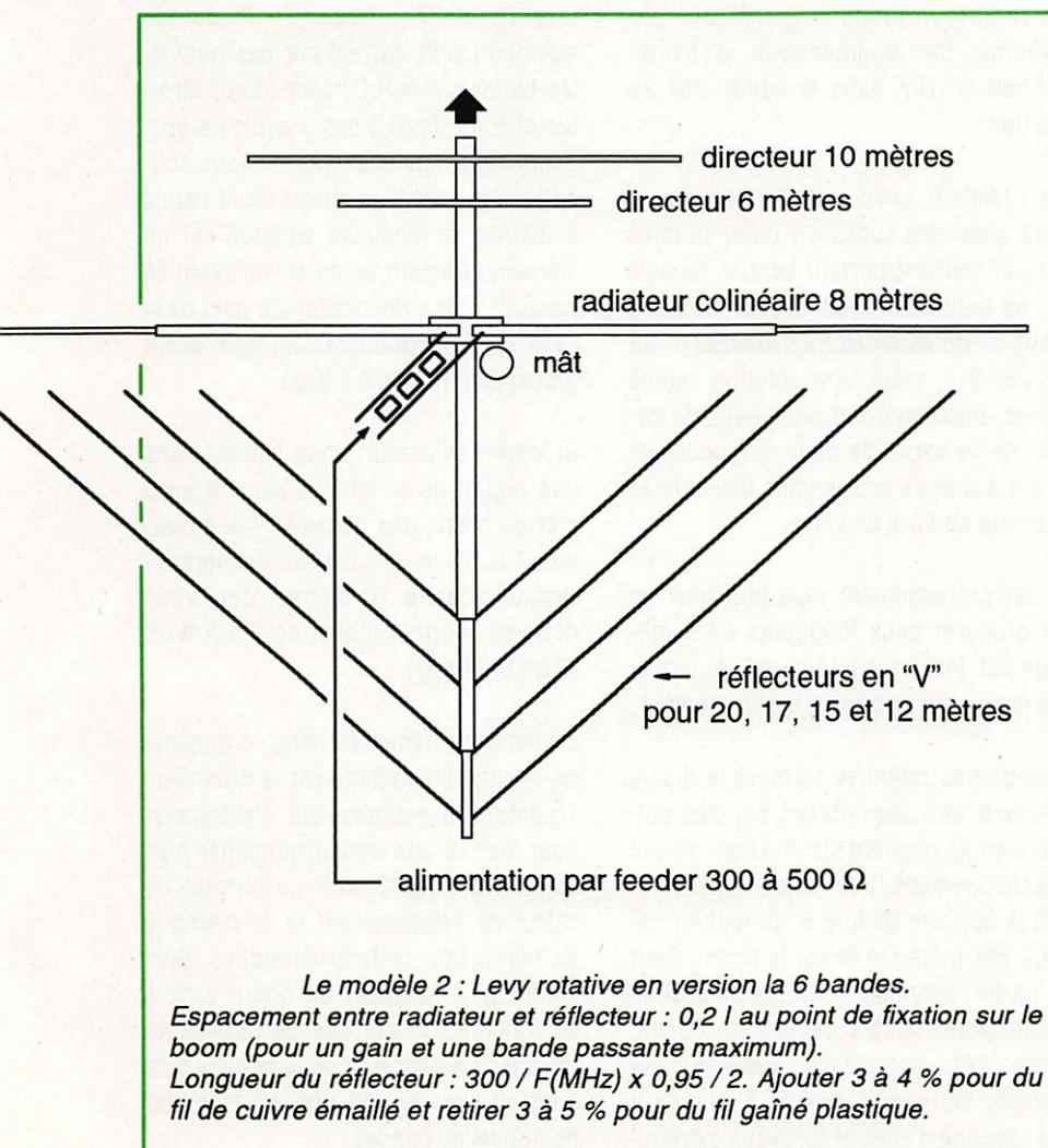
avons maintenant un total de cinq éléments (un radiateur, trois réflecteurs en "V" et un élément directeur) d'où le nom "V5". Par rapport à un système tribandes à trappes classique, ce montage présente les avantages suivants :
