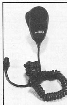
qué par K40 Electronics. Le compresseur de modulation, intégré au micro, rendra votre «module» plus percutive, plus efficace, tout en assurant une limitation de gain. L'originalité de ce micro, c'est qu'il prélève la tension d'alimentation directement sur le circuit de commutation de l'émetteur-récepteur CB. Un condensateur chimique, de forte capacité, assure le maintien de cette tension aux bornes du circuit intégré C-MOS qui
