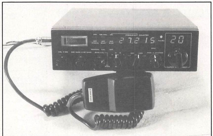
*Le fréquencemètre en face avant.*
