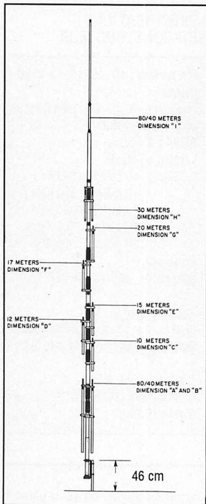
en terre sur environ 1 mètre, tel que présenté sur la photo. Il n'y a pas eu besoin de mettre les radians. Le TOS a été bon de suite, mais, sur des bandes nettement supérieures, la fréquence de résonance était trop élevée, ce malgré un calcul préliminaire rectificatif de la notice. Les réglages se font en agissant sur les pistons des éléments ca-
