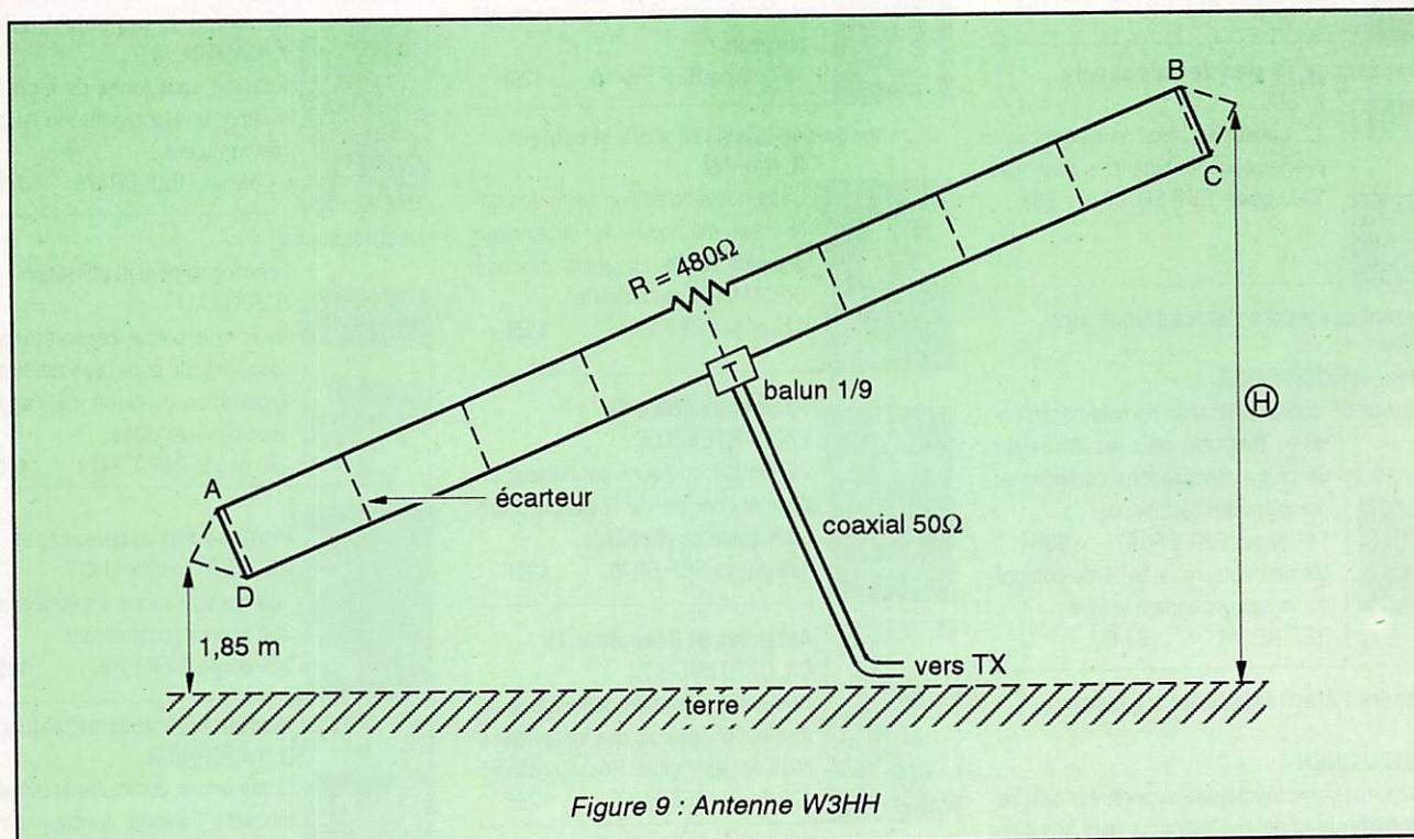
Trois groupements en série, comptant chacun 10 résistances non bobinées de  $1,6 \text{ k}\Omega / 3 \text{ W}$ , réalisent R. Le coaxial doit rester perpendiculaire à CD sur un trajet d'au moins 20 m, si besoin est.
