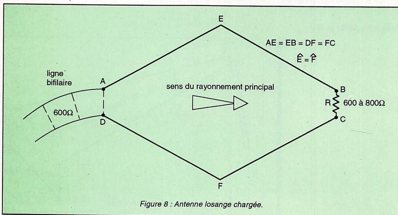
Figure 8 : Antenne losange chargée.
