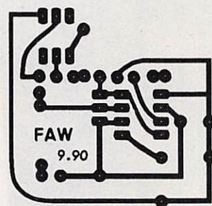
Figure 4 : Le CI, côté soudures, du module d'adaptation.
