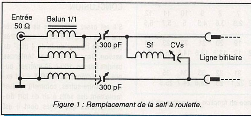
Figure 1 : Remplacement de la self à roulette.
