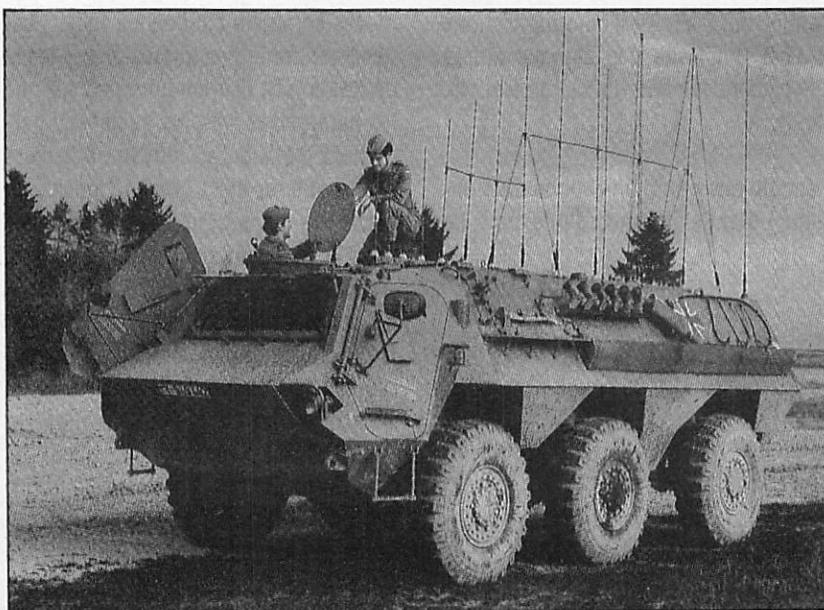
*Brouilleur VHF installé sur un véhicule blindé.*
