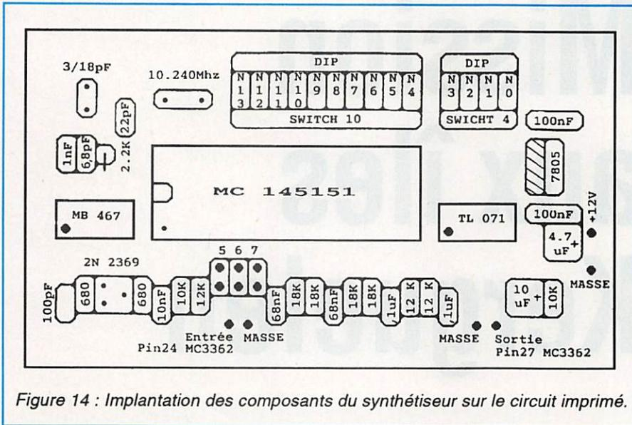
Figure 14 : Implantation des composants du synthétiseur sur le circuit imprimé.
