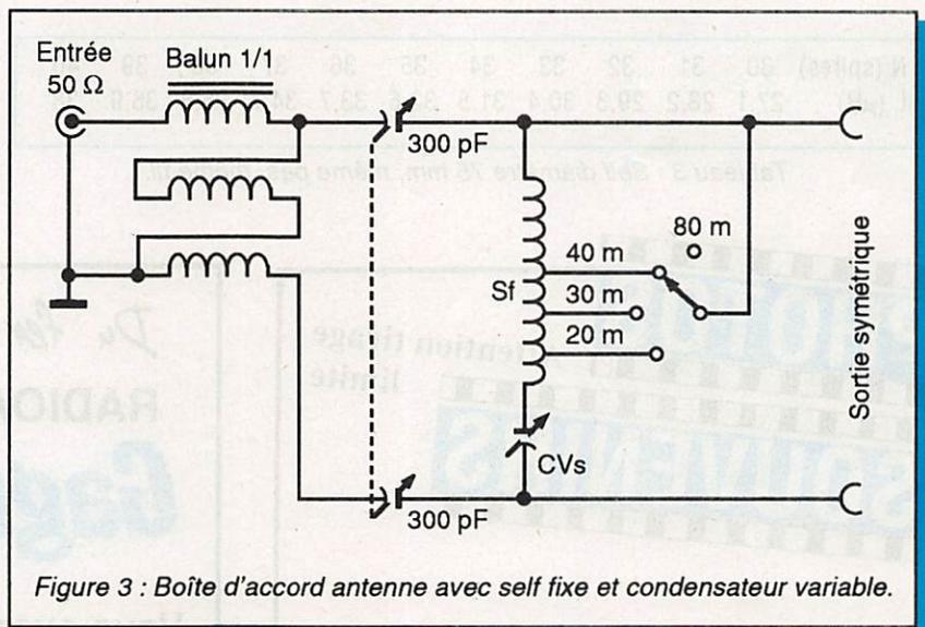
Figure 3 : Boîte d'accord antenne avec self fixe et condensateur variable.
