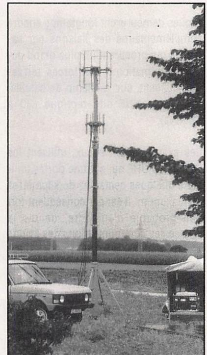
*Radiogoniomètre VHF-UHF transportable.*
