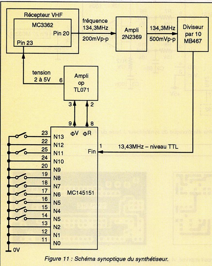
Avant, il faut bien sûr débrancher l'ancienne commande du VCO en retirant au moins le curseur du potentiomètre de la broche 27 du MC3362, ou en mettant un inverseur, pour pouvoir sélectionner le VFO ou le synthétiseur qui, alors, sert de mémoire.
