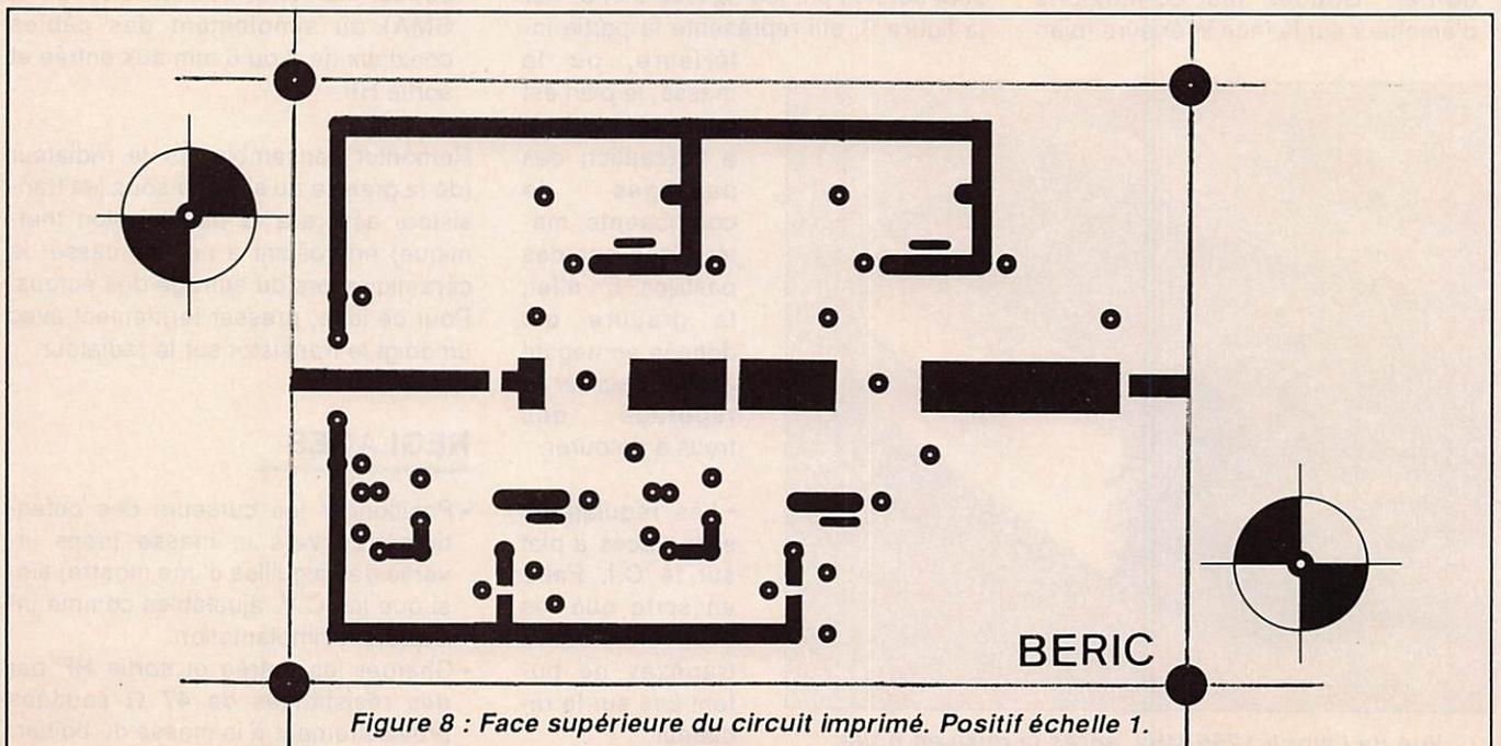
Figure 8 : Face supérieure du circuit imprimé. Positif échelle 1.
