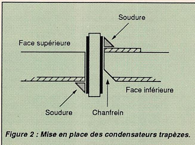
Figure 2 : Mise en place des condensateurs trapèzes.
