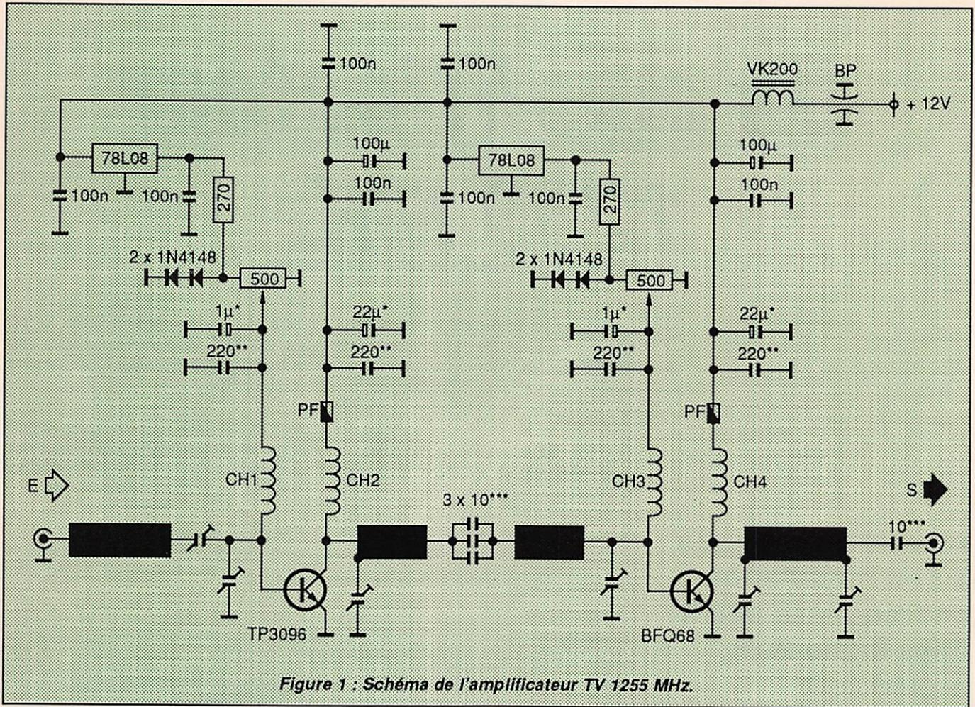
Figure 1 : Schéma de l'amplificateur TV 1255 MHz.
