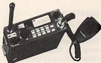
**YAESU - FT 757GX//.** Transceiver décimétrique nouvelle technologie, couverture générale de 500 kHz à 30 MHz en réception, émission bandes amateurs. Tous modes + entrée AFSK et Packet. 100 W. Alimentation 13,8 Vdc. Dimensions 238 x 93 x 238 mm, poids 4,5 kg. Option interface de télécommande pour Apple II ou RS 232C et cartouche MSX.
