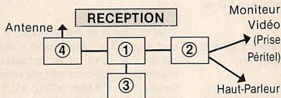
**RVS ①** Tuner accordable de 950 MHz à 1750 MHz.
