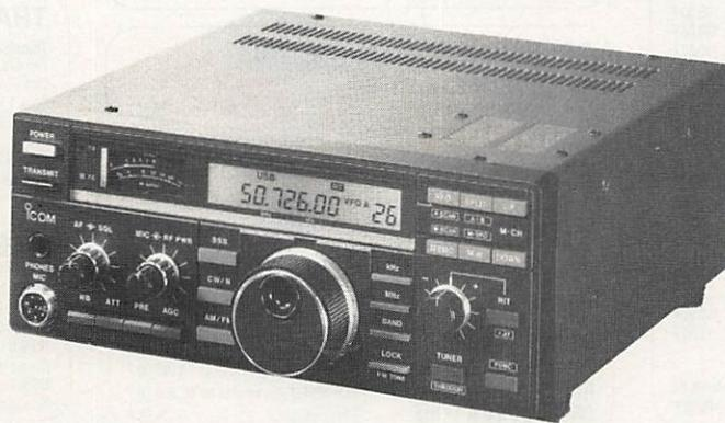
connu des amateurs mais avec une bande FM supplémentaire puisque qu'il couvre de 42 MHz à 61 MHz, donc la bande récemment attribuée du 50 MHz. L'IC 2400E est un transceiver bi-bande 144 et 432 prévu pour le montage en mobile. Deux possibilités : 45 W ou 5 W en 144 et 35 W ou 5 W en 432. L'IC 24 est aussi un transceiver bi-bande, de type portatif, très compact, avec disposant de 5 W en "forte" puissance et d'environ 500 mW en puissance réduite.
