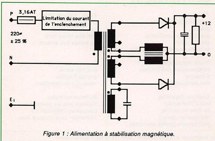
Figure 1 : Alimentation à stabilisation magnétique.
