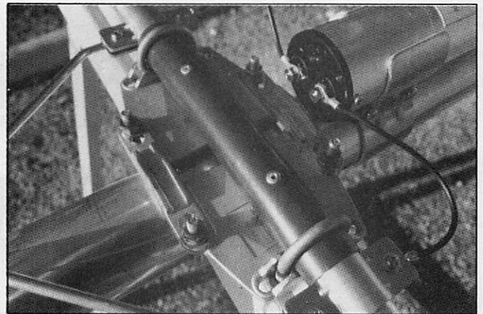
Le montage de l'élément rayonnant avec le balun et son système de fixation.
