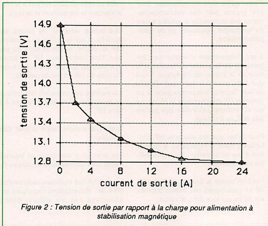
Figure 2 : Tension de sortie par rapport à la charge pour alimentation à stabilisation magnétique
