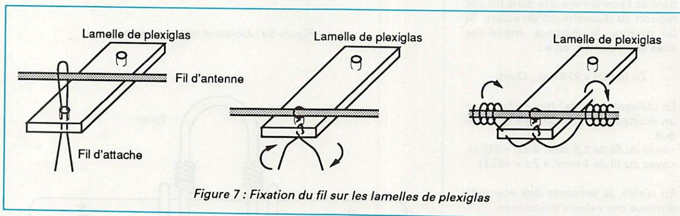
Figure 7 : Fixation du fil sur les lamelles de plexiglas
