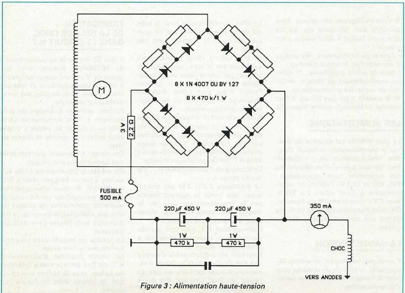
Figure 3 : Alimentation haute-tension
