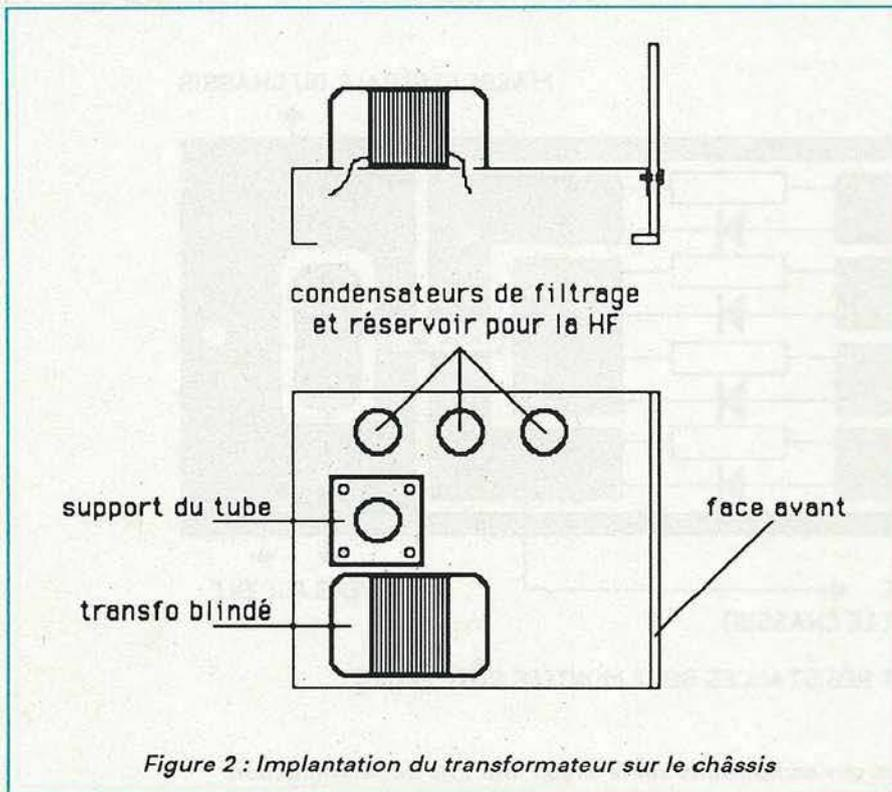
Figure 2 : Implantation du transformateur sur le châssis
