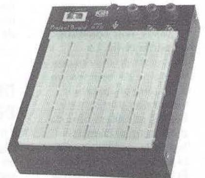
électroniques. Il comprend un jeu de plaquettes de connexions au pas de 2,54 mm interchangeables (SFI 1-47 06 30 77).
