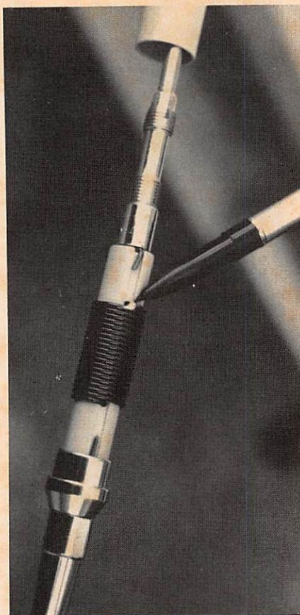
*Photo 2 : Emplacement de la soudure sur la self.*
