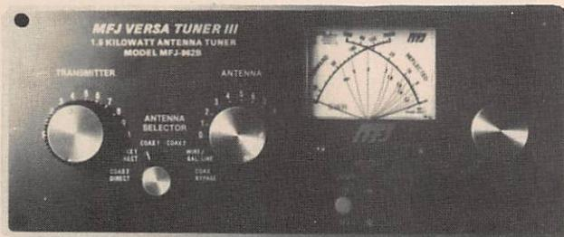
La boîte d'accord antenne MFJ "VERSA TUNER III"
