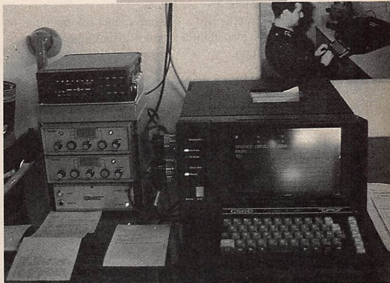
Radiotéléphone HF BLU 2 à 30 MHz 125 W Motorola MICOM XR.
