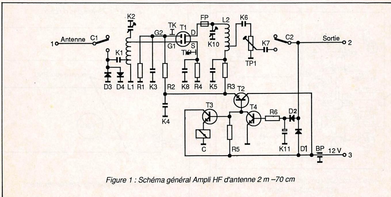
Figure 1 : Schéma général Ampli HF d'antenne 2 m - 70 cm
