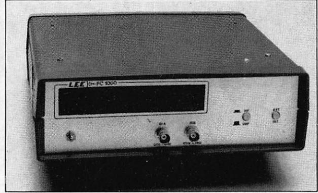
Fréquencemètre 10 Hz à 1,2 GHz
