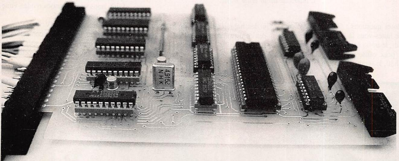
L'article qui suit décrit la réalisation, le fonctionnement et la programmation d'une interface série répondant aux normes V24 ou RS232 et connectable sur le bus d'extension des 464-664-6128. Les principales caractéristiques techniques de cette carte sont :
