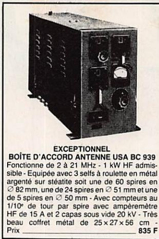
**BOÎTE D'ACCORD ANTENNE USA BC 939** Fonctionne de 2 à 21 MHz - 1 kW HF admissible - Equipée avec 3 selfs à roulette en métal argenté sur stéatite soit une de 60 spires en Ø 82 mm, une de 24 spires en Ø 51 mm et une de 5 spires en Ø 50 mm - Avec compteurs au 1/10<sup>e</sup> de tour par spire avec ampèremètre HF de 15 A et 2 capas sous vide 20 kV - Très beau coffret métal de 25 x 27 x 56 cm - Prix - 835 F
