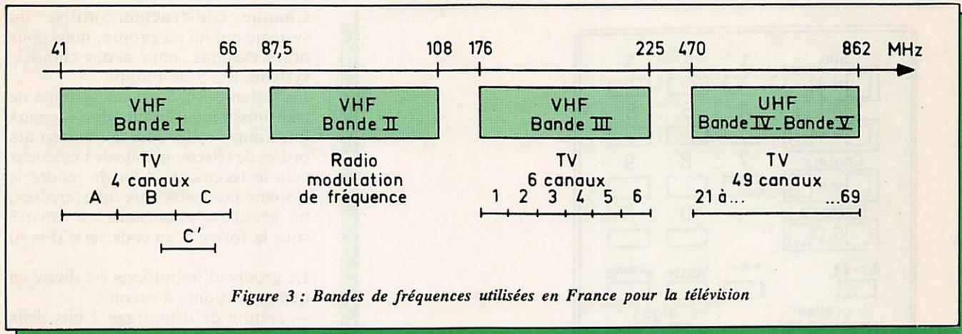
de conversion est possible, la forme du filtre FI aux normes L s'y prêtant, en choisissant une porteuse FI vision à 37,700 MHz, la FI son étant de 32,200 MHz. Ces conversions HF/FI sont illustrées par la figure 2. Le découpage pour les normes d'émission L et L' utilisées en France est en figure 3
