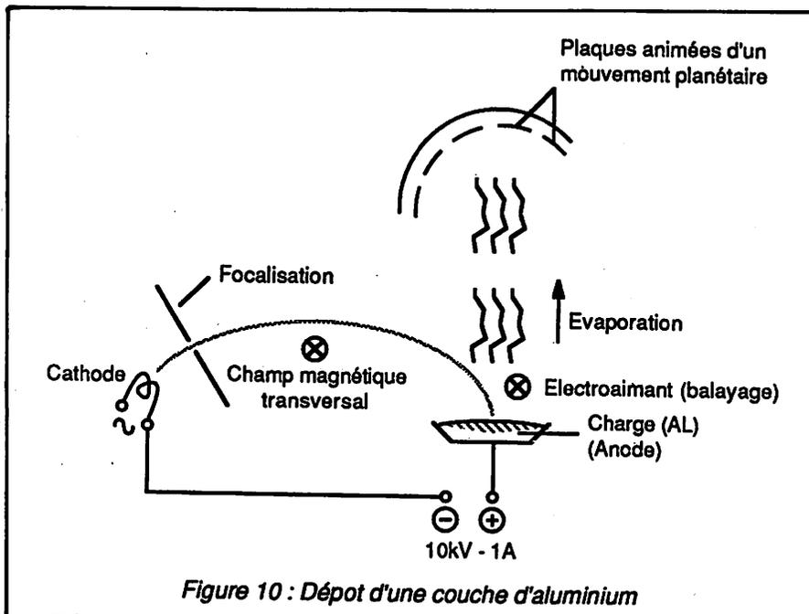
Figure 10 : Dépôt d'une couche d'aluminium
