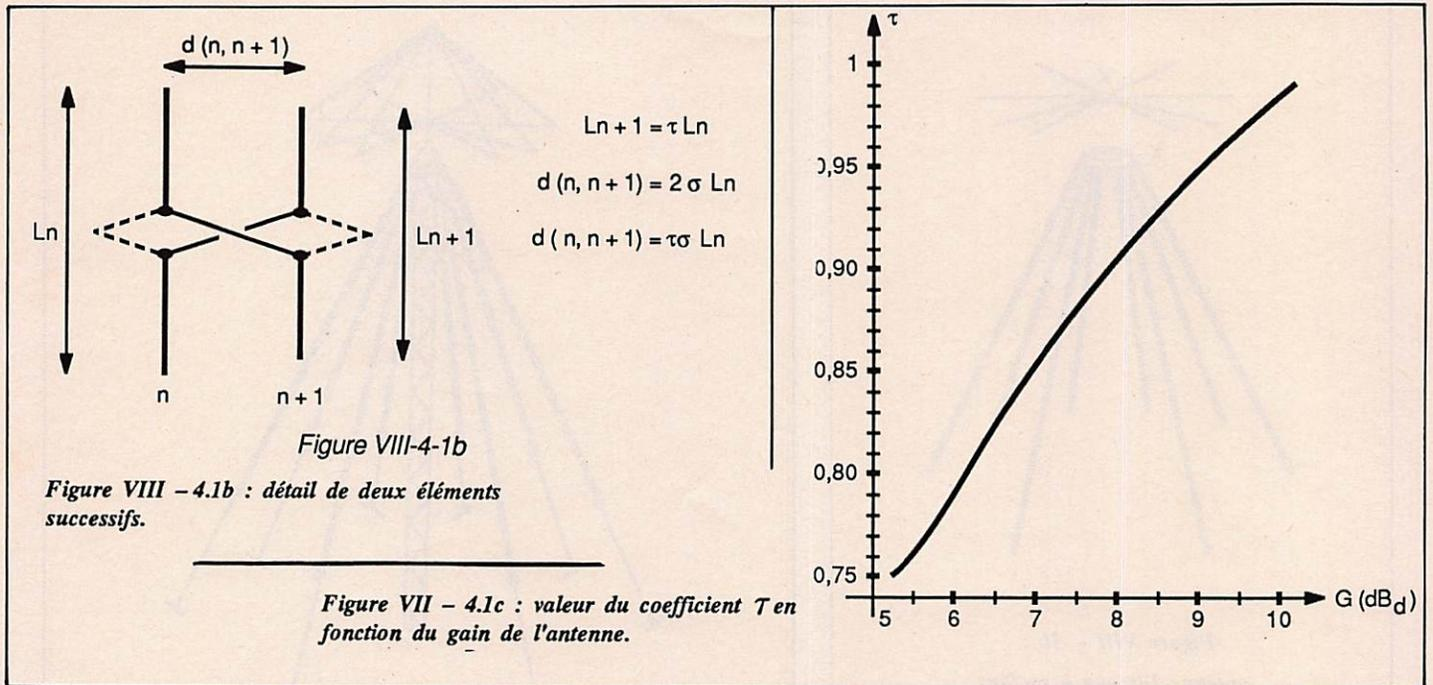
A chaque fréquence, seuls quelques éléments de l'antenne sont donc concernés, on parle de cellule active ; le gain de l'aérien ne dépend pas du nombre total d'éléments de l'antenne, mais du nombre d'éléments de la cellule active ; ce nombre dépend de  $\tau$  et  $\sigma$  et du gain désiré.
