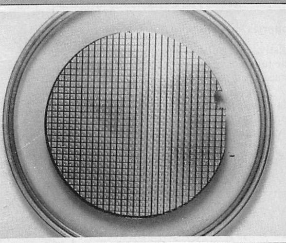
V - Wafer prêt pour la découpe des différents transistors
