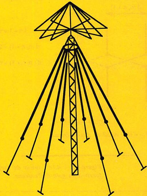
Figure VIII - 3c : antenne Discone pour bandes basses décadiques.
