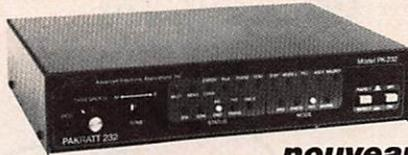
**AEA - PK 232.** Contrôleur de Packet Radio. Programme de communication interne 300, 1200, 2400, 4800 et 9600 bauds. Décodage et protocole pour CW, RTTY (Baudot et ASCII), AMTOR, PACKET. HF et VHF. Modem VHF/HF/CW. Bande passante automatique.
