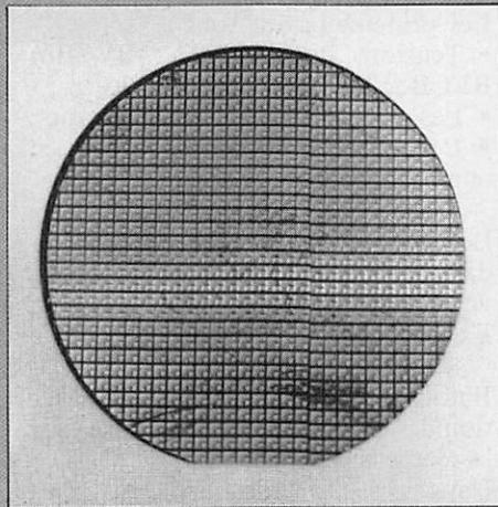
III - Wafer couvert de transistors
