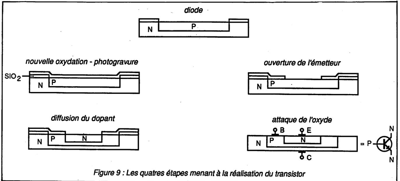
Figure 9 : Les quatre étapes menant à la réalisation du transistor
