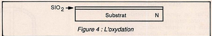
Figure 4 : L'oxydation
