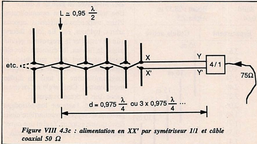
XX' ne pourrait être constante sur toute la plage de fréquences car cette ligne se termine de façon non adaptée sur l'élément le plus long et cela crée des résonances. On limite donc l'espacement à quelques centimètres, comme indiqué sur les dessins.
