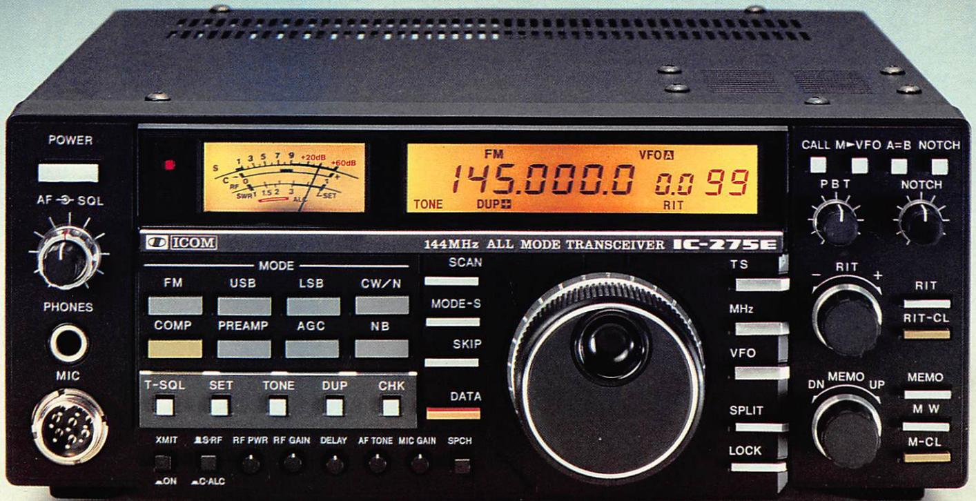
L'IC-275 E est équipé du système ICOM DDS (Direct Digital Synthesiser) permettant un verrouillage en moins de 5 millisecondes. De ce fait, il est l'outil idéal pour qui pratique les modes PACKET et AMTOR\*.
