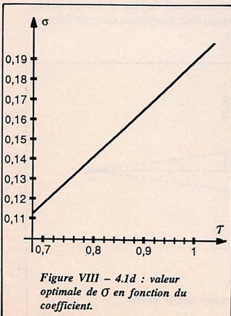
Les courbes 4-1 c et d donnent les valeurs optimales à retenir pour  $\tau$  et  $\sigma$ , aux fréquences extrêmes  $F_{min}$  et  $F_{max}$  correspondent des longueurs d'onde :
