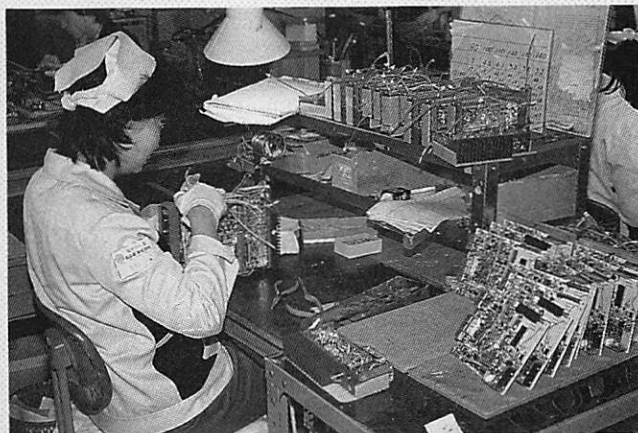
Insertion des sous-ensembles dans les boîtiers.
