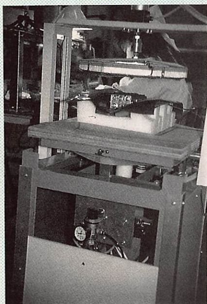
Banc testant la résistance aux vibrations.
