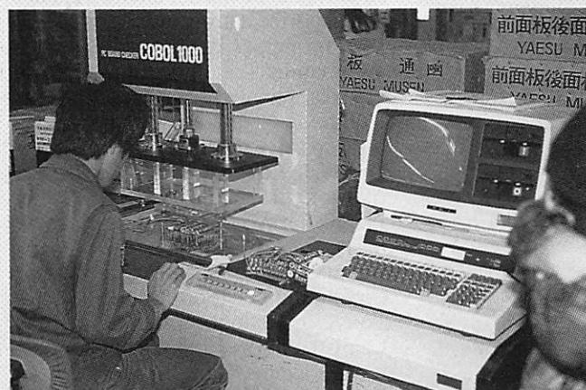
Test automatique des sous-ensembles.
