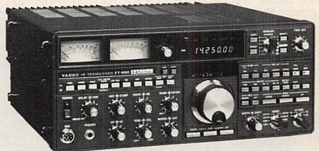
Transceiver décimétrique réception de 150 kHz à 30 MHz, émission bandes amateurs. Tous modes. 120 W HF. Tout transistor. Alimentation 220 Vac. Option interface de télécommande pour APPLE II.
