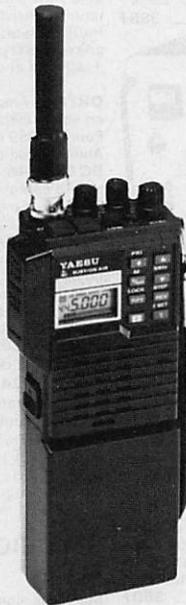
**FT 23R** - Transceiver portable FM 144-146 MHz. 10 mémoires avec shift dont 7 programmables avec des shifts non standard. Scanning. Affichage LCD des fréquences et mémoires et par bar-graph pour le signal reçu. Boîtier métallique. Puissance : 2 à 5 W\*. Dimensions : 55 x 32 x 122/139/188\*. Poids : 430 à 550 g\*.
