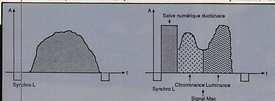
La figure de gauche est la représentation simplifiée d'une ligne d'un signal de télévision analogique conventionnel.
