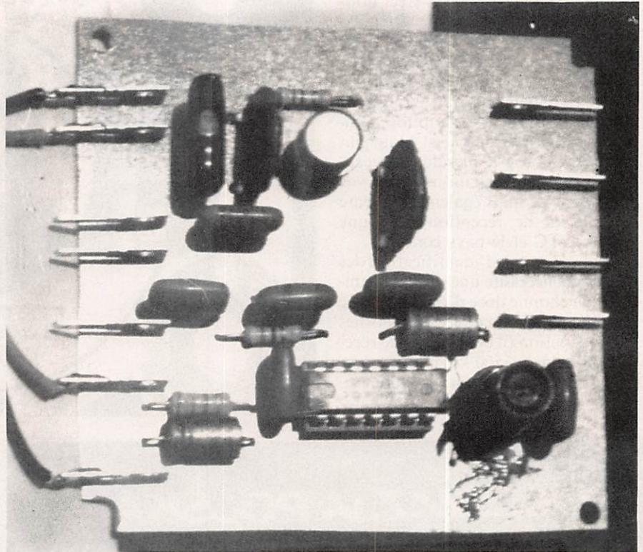
dard, soit d'incorporer à un téléviseur uniquement prévu pour le standard français, une platine d'adaptation
