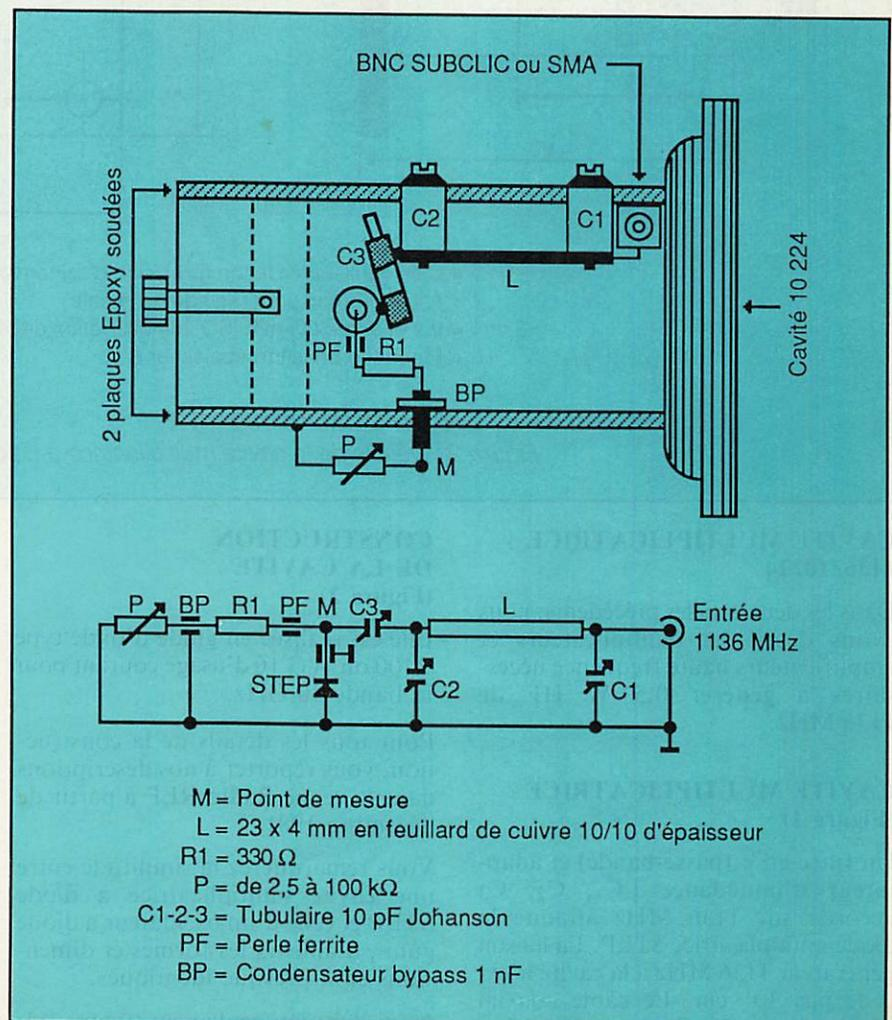
Figure 1 : Schéma Multiplicateur 1136 → 10 224 MHz
