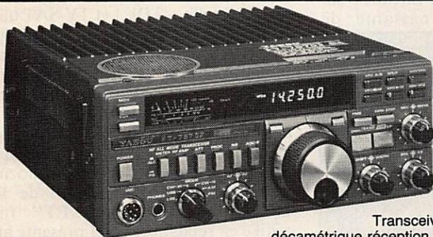
Transceiver décimétrique réception de 150 kHz à 30 MHz, émission bandes amateurs. Tous modes. 100 W. Alimentation 13,8 Vdc. Dimensions 238 x 93 x 238 mm. Poids 4,5 kg. Option interface de télécommande pour APPLE II. FT 757SX. Idem mais puissance 10 W.
