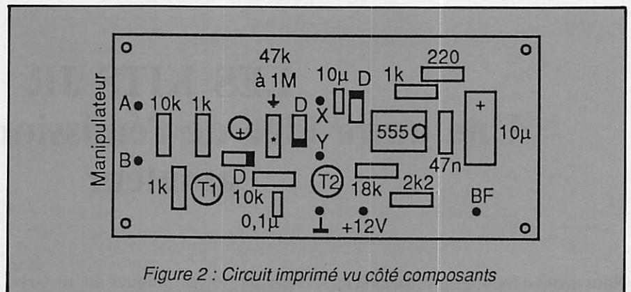
Figure 2 : Circuit imprimé vu côté composants
