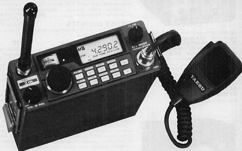
Transceiver portable 144-146 MHz. Tous modes. 2 VFO synthétisés. 10 mémoires (fréquence, mode, shift). Sélection du pas suivant le mode (FM : 12,5/25/50 kHz ; SSB et CW : 25/100/2500 Hz). Semi-duplex entre les deux VFO et touche «reverse». Scanning manuel/automatique. 2,5 W. Noise blanker tous modes, clarifier, CW semi-break in. Dimensions : 150 x 57 x 194 mm. Poids : 1,2 kg.
