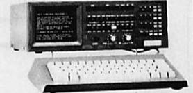
**TONO - 5000E.** Codeur-Décodeur pour émission-réception en CW, RTTY (Baudot & ASCII) et AMTOR.
