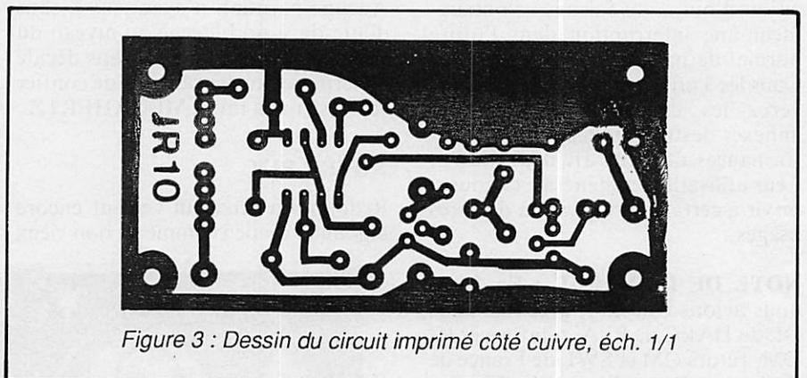
Figure 3 : Dessin du circuit imprimé côté cuivre, éch. 1/1
