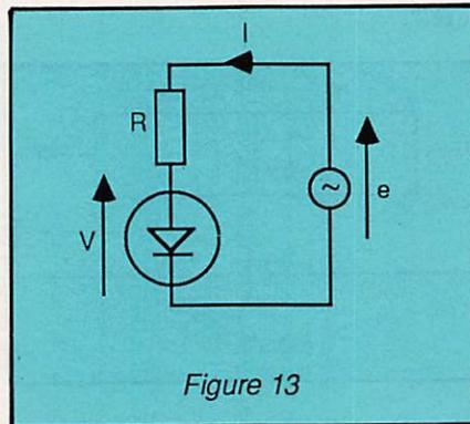
Sur la figure 14, on voit que, pendant l'alternance positive de  $e$ , la diode est passante : la tension à ses bornes est nulle (en réalité  $0,7 \text{ V}$ ), et le courant suit la loi sinusoïdale de  $e$ .
