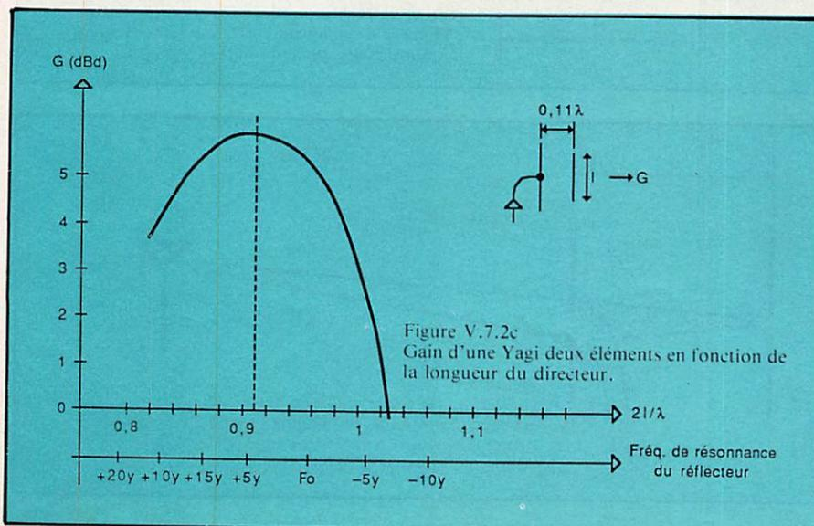
par cet élément est réfléchi vers le radiateur avec une phase correcte pour s'ajouter à celle venant directement du correspondant ; cet élément parasite est appelé *réflecteur* ; il est plus long que l'élément rayonnant (5 à 10 % plus long).
