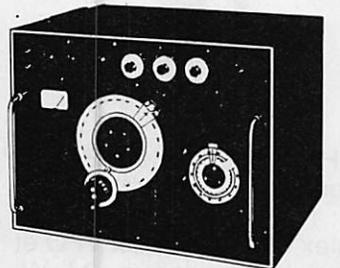
GS 117 - couvre de 7 à 11 GHz - sortie 50 ohms à 0 dB, 1 mW - Atténuateur de 0,2 Volts à 0,1 µV + Dbm - Modulation: pure, impulsions, carré, FM - Convient particulièrement aux mesures sur Récepteurs antennes et lignes de transmission. Secteur 220 V - 53 x 50 x 47 cm **2930 F**
