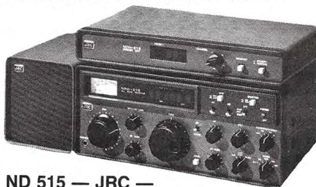
**ND 515 — JRC** — Récepteur semi-professionnel entièrement synthétisé, couvre de 100 kHz à 30 MHz en 30 gammes. Affichage digital de la fréquence. Modes AM/SSB/CW/RTTY. Sélectivité commutable et réglable: 6 kHz - 2,4 kHz. *En option*: 600 Hz - 300 Hz.
