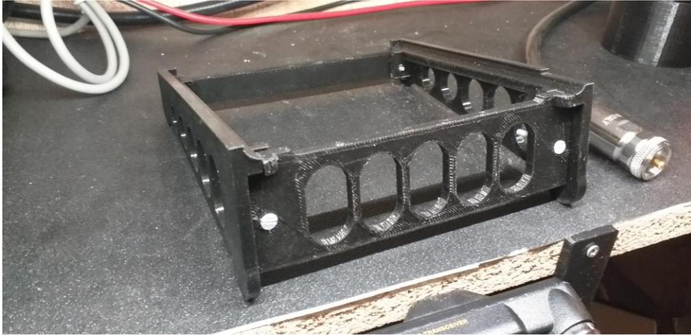
Support en 4 pièces pour utilisation au QRA du ft 917/818 en PLA (réalisation)
