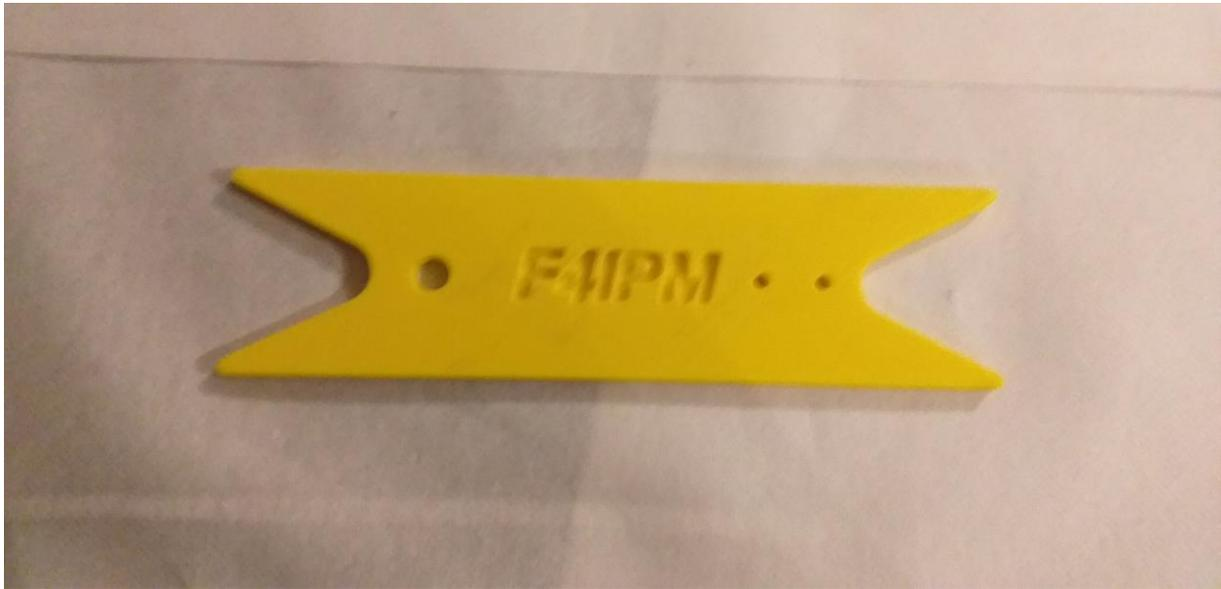
Isolant/extrémité d'antenne filaire en PLA : à droite deux trous alésés pour laisser passer le câble d'antenne et régler la longueur, à gauche un trou plus conséquent recevant le piquet de tente planté au sol.(création).
